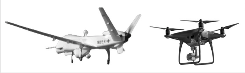
[그림 1] 고정익(左) 및 회전익(右) 드론의 외형적 모습
